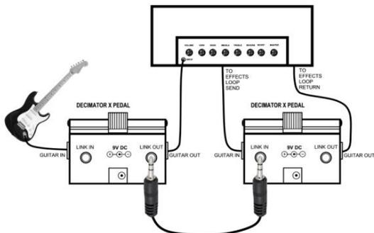
左のダイアグラムは、2台のDecimator Xペダルをリンクさせ、2台目のペダルが直接インストールメント入力をトラッキングする方法を示しています。これにより、2台目のペダルの内部レベルディテクターがギターを直接トラッキングし、プロ仕様のラックマウント型Decimator ProRack Gと同様のトラッキング性能が得られます。
